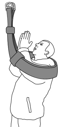
Einstieg bei geschlossener Rettungsschlinge
