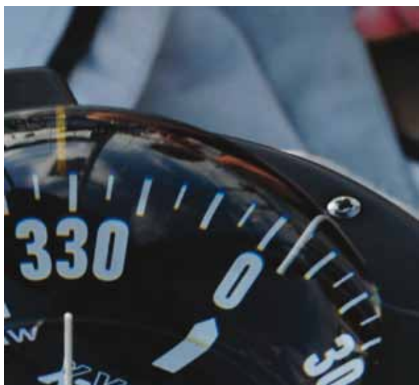
Als Steuerkompass geeigneter Magnetkompass
