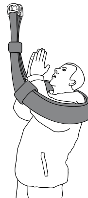
Einstieg bei geschlossener Rettungsschlinge
